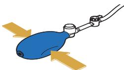
6. Revoyez la position de l'utilisateur sur le coussin et dans le fauteuil. Si des adaptations supplémentaires sont nécessaires, tournez d'abord la valve de sécurité en position ouverte (parallèle). Ensuite, appuyez sur le bouton de déverrouillage noir de la pompe à ballon et maintenez-le enfoncé pendant 5 secondes minimum afin de relâcher l'air des poches de verrouillage et répétez les étapes 2 à 5 de cette section. Cela garantira le maintien de la position d'assise souhaitée.
